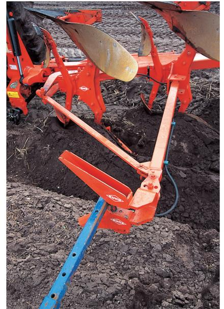
Rameno je k dispozici pro všechny řady pluhů. Umožňuje připojení pěchů pro úpravu zoraného pole s hydraulickým zámkem. Na části ramene se závěsným hákem, tam kde je největší nebezpečí poškození, jsou všechny mazničky a hydraulická potrubí chráněny uvnitř konstrukce hlavy. Při dopravě se rameno vyklápí směrem nahoru.
